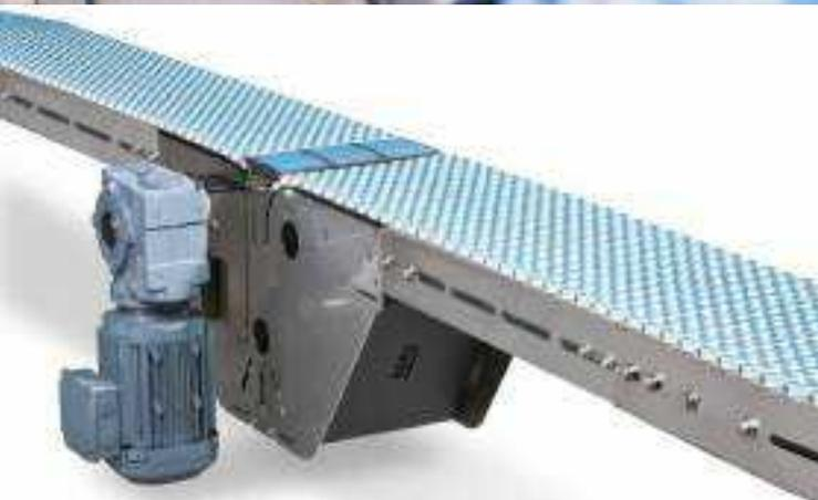
Basado en el principio modular, los mismos componentes pueden ser usados para todos los transportadores. La banda modular multiflex plastic, permite el transporte horizontal, vertical y la realización de curvas, garantizando el flujo continuo de productos. Es económico y ahorra espacio. El ancho puede ser desde 255, 340, 425 y 510mm y transporta productos de hasta 700mm de ancho.
